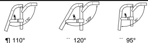
4 Vorderrahmen hochklappbar, wegschwenkbar und abnehmbar
