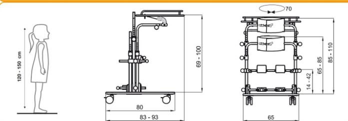
MINI STAN DY 3 GEWICHT 23 kg. MAXIMALE BELASTUNG 55 kg.
