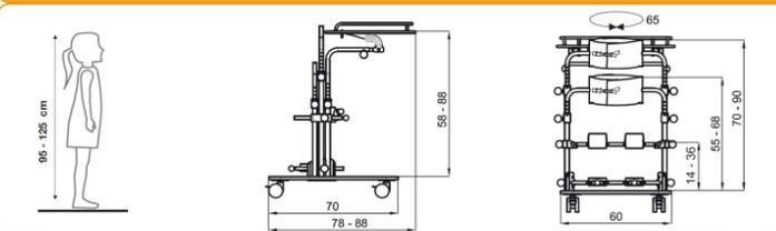
MINI STAN DY 2 GEWICHT 21 kg. MAXIMALE BELASTUNG 45 kg.
