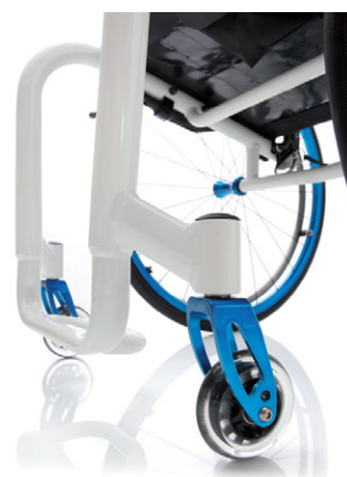
Maßgefertigte vollverschweißte Lenkradaufnahme
